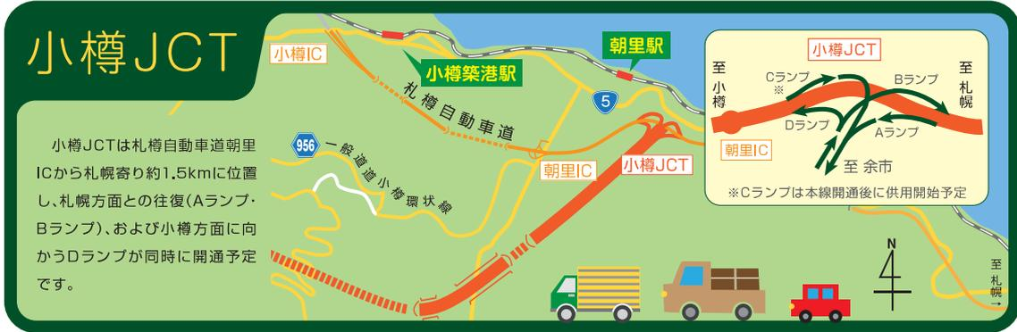
小樽JCTは札幌自動車道朝里ICから札幌寄り約1.5kmに位置し、札幌方面との往復(Aランプ・Bランプ)、および小樽方面に向かうDランプが同時に開通予定です。
