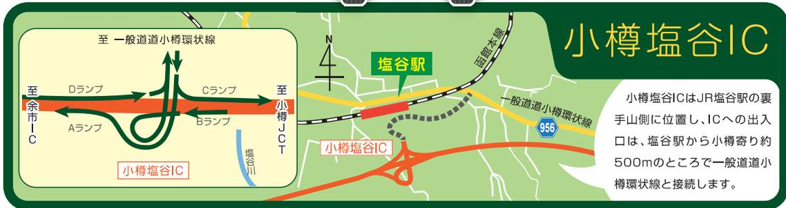
小樽塩谷ICはJR塩谷駅の裏手山側に位置し、ICへの出入口は、塩谷駅から小樽寄り約500mのところまで一般道道小樽環状線と接続します。
